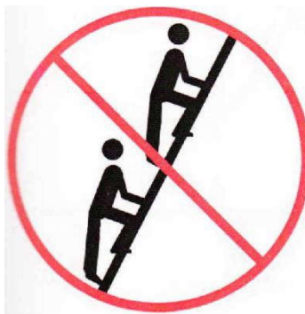
Tik vienam asmeniui galima lipti ant pagrindinės kopėčių arba laiptinių kopėčių pusės
