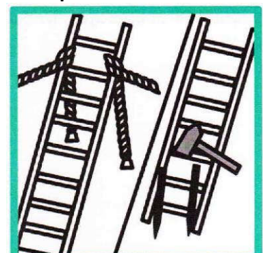
- Pritvirtinti kopėčių viršų ir apačią
