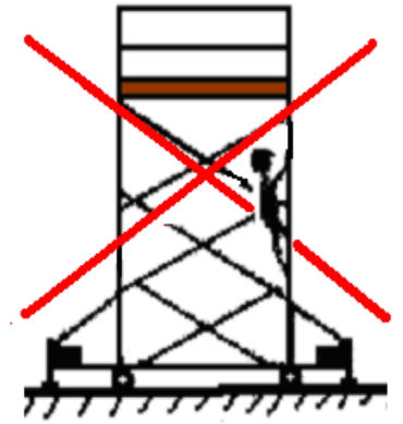
15 pav. Draudžiama dirbti aukštyje atvirose vietose kai vėjo greitis yra 15 m/s ir didesnis
