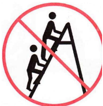
Tik vienam asmeniui galima lipti ant pagrindinės kopėčių arba laiptinių kopėčių pusės
