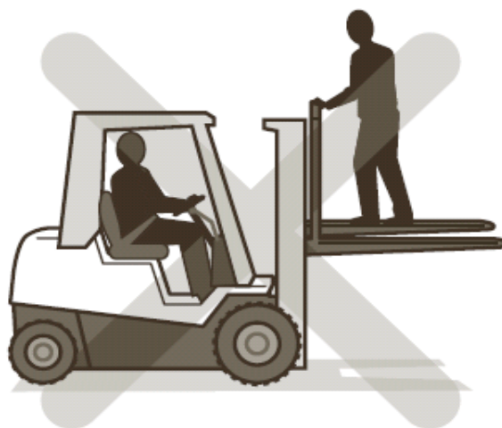
17 pav. Draudžiama darbo vietai paaukštinti naudoti tam nepritaikytus krautuvus
