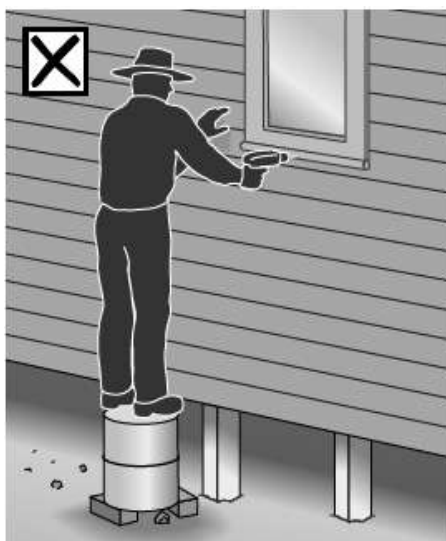
18 pav. Draudžiama naudoti atsiktines paaukštėjimo priemones
